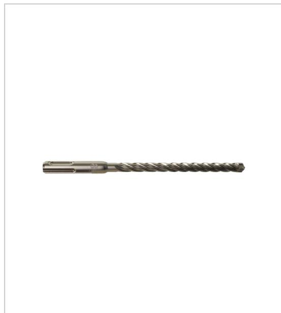
Applications : béton, béton armé, pierre, granit, brique pleine 4X90°: 4 taillants symétriques au carbure design variable de la flute (fine au niveau de la tête pour une meilleure évacuation des débris et plus épaisse à la base pour plus de résistance) vitesse de pénétration rapide, longévité accrue, trou circulaire précis, évacuation optimale des poussières.
