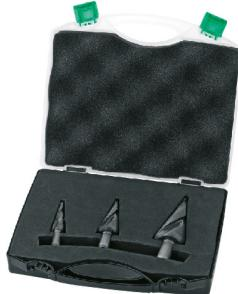
Très appropriés : aciers alliés, aciers non alliés et faiblement alliés, inox appropriés : fontes, alliages d'aluminium, cuivres, et plastiques goujure hélicoïdale surface nitruré coupe à droite Ø 1 (M4-M12) 2 (M4-M20) 3 (M6-M30) en coffret plastique.
