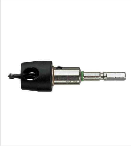
Pour les perceuses-visseuses sans fil et perceuses-visseuses à percussion sans fil Festool à raccord CENTROTEC (pour l'utilisation dans le mandrin WH-CE CENTROTEC) ; butée de profondeur réglable avec foret interchangeable; longue durée de vie grâce au carbure rapporté
