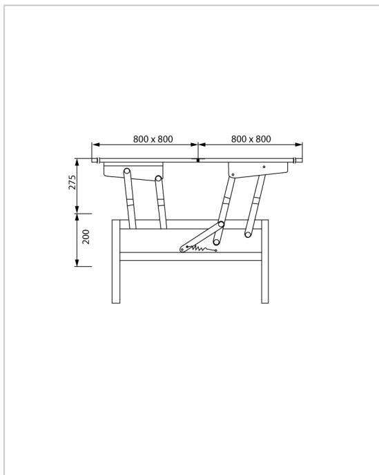
Ce mécanisme permet de surélever le plateau d'une table basse et de doubler sa surface grâce à son système de double plateau.
