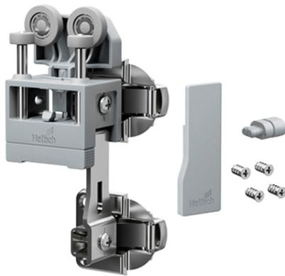
WingLine L permet de réaliser des portes coulissantes pliantes (ouverture 110°) pour les agencements sous escalier ainsi que les placards standards et de grandes dimensions (jusqu'à 2400 mm de hauteur et 600 mm de largeur par vantail).
