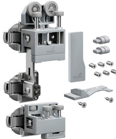
WingLine L permet de réaliser des portes coulissantes pliantes (ouverture 110°) pour les agencements sous escalier ainsi que les placards standards et de grandes dimensions (jusqu'à 2400 mm de hauteur et 600 mm de largeur par vantail).
