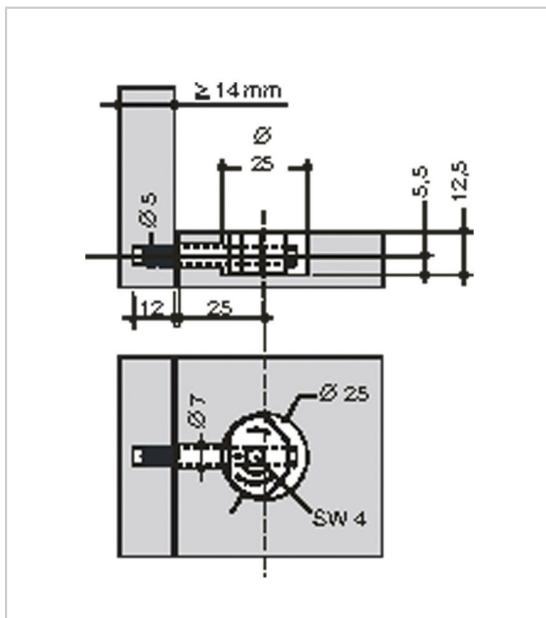
Ferrure pour l'assemblage de caissons.
