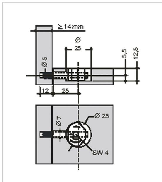
Ferrure pour l'assemblage de caissons.
