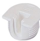
Ferrure d'assemblage VB 135 La ferrure d'assemblage VB 135 est à enfonce dans un trou de diamètre de 20mm. Le fond peut être installé par le dessus. Le fond et la ferrure d'assemblage sont ensuite enfoncés sur le goujon. La forme conique du logement permet de serrer la tablette et de l'assurer contre tout décrochement. Utilisable pour des fond d'un épaisseur à partir de 16mm !
