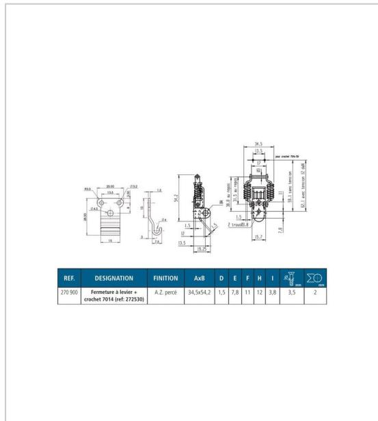
Fermerture à levier 7019 livrée avec crochet 7014.50 (compatible avec crochets 7010.50)
