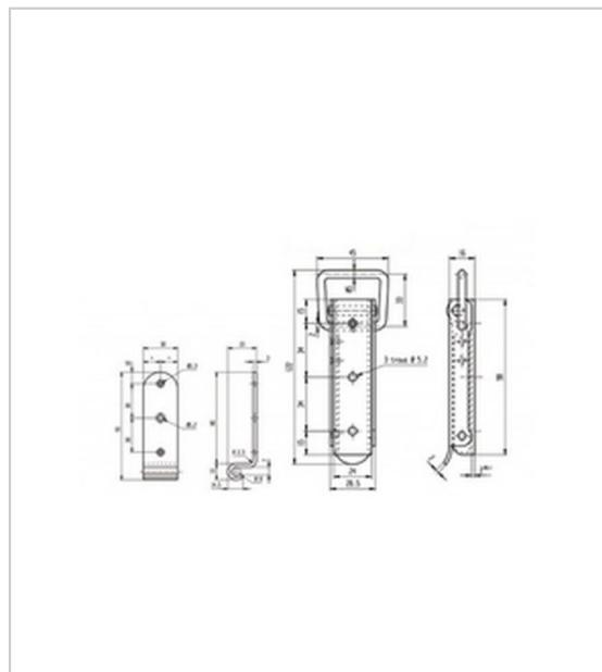
Fermeture à levier 7006 en acier zingué livrée avec crochet 7006.50 coudé
