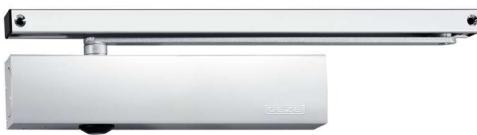
Ferme-porte en applique pour porte battante à 1 vantail et simple action. Montage réversible droite/gauche, côté paumelles ou opposé aux paumelles.
