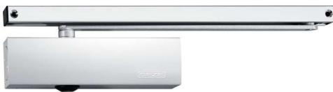
Ferme-porte en applique pour porte battante à 1 vantail et simple action. Montage réversible droite/gauche, côté paumelles ou opposé aux paumelles.
