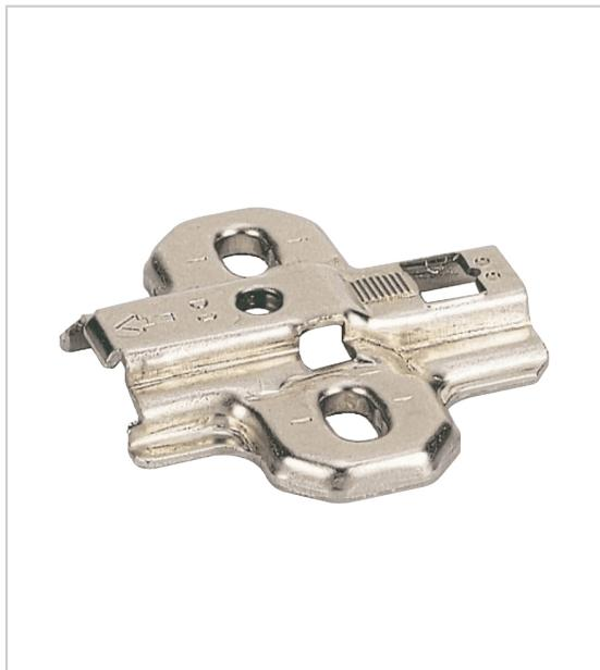
Plaque de montage en croix à visser à trous oblongs diamètre 5,4 mm pour réglage de hauteurFixation avec vis à bois à tête fraisée diamètre 4,5 mm
