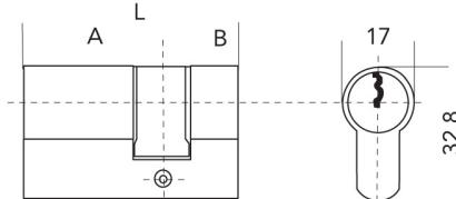
Cylindre laiton nickelé 16 pistons Haute sécurité
