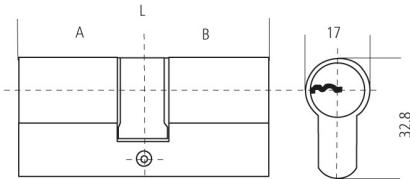
Laiton nickelé 6 pistons
