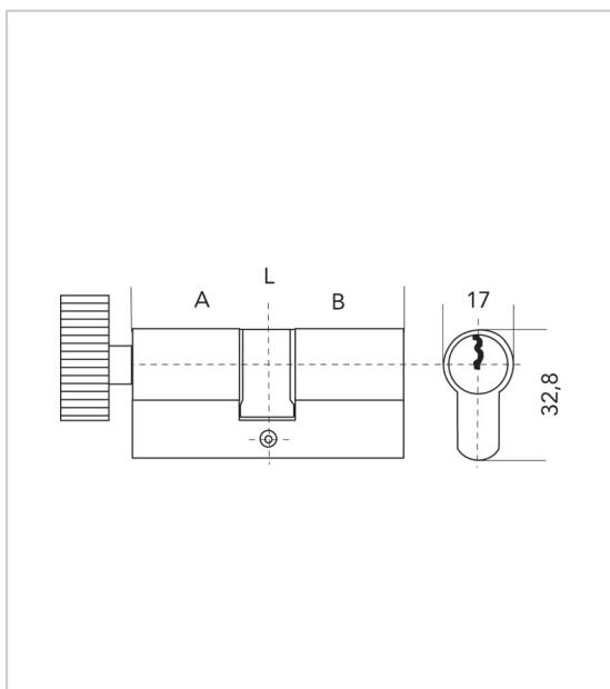
Cylindre laiton nickelé 16 pistons Haute sécurité
