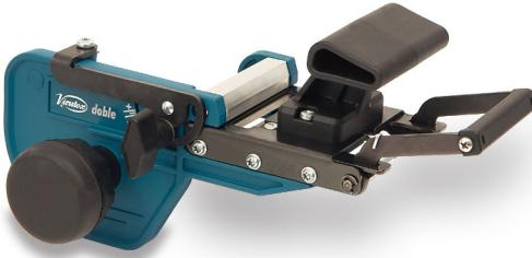
Appareil pour la coupe des excédents de chants aux deux extrémités des panneaux droits et de l'excédent des panneaux circulaires. La qualité du travail évite tout dommage sur le panneau ou le chant. Coupe des chants jusqu'à 55 mm de largeur et 1 mm d'épaisseur ou 25 mm de largeur et 3 mm d'épaisseur. Le système à guillotine permet une coupe parfaite avec le moindre effort, même sur des chants épais. Permet la coupe jusqu'à des angles de 60°.
