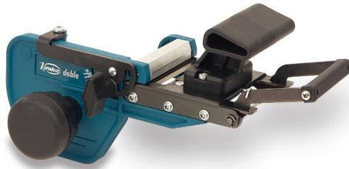
Appareil pour la coupe des excédents de chants aux deux extrémités des panneaux droits et de l'excédent des panneaux circulaires. La qualité du travail évite tout dommage sur le panneau ou le chant. Coupe des chants jusqu'à 55 mm de largeur et 1 mm d'épaisseur ou 25 mm de largeur et 3 mm d'épaisseur. Le système à guillotine permet une coupe parfaite avec le moindre effort, même sur des chants épais. Permet la coupe jusqu'à des angles de 60°.
