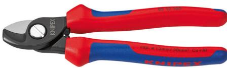
Pour couper les câbles en cuivre et en aluminium, unifilaires et multifilaires ne convient ni à la coupe du fil d'acier ni à des conducteurs en cuivre étirés à froid tranchants trempés, meulés avec précision coupe nette du câble et sans écrasement coupe facile avec prise d'une seule main ergot de protection évitant les pincements charnière vissée réglable, sécurité automatique acier à outils de qualité spéciale, forgé, trempé à l'huile version brunie, poignées avec gaines bi-matière.
