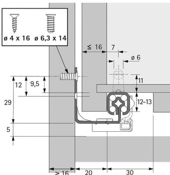
Montage par clipsage et réglage en hauteur sans outil.
