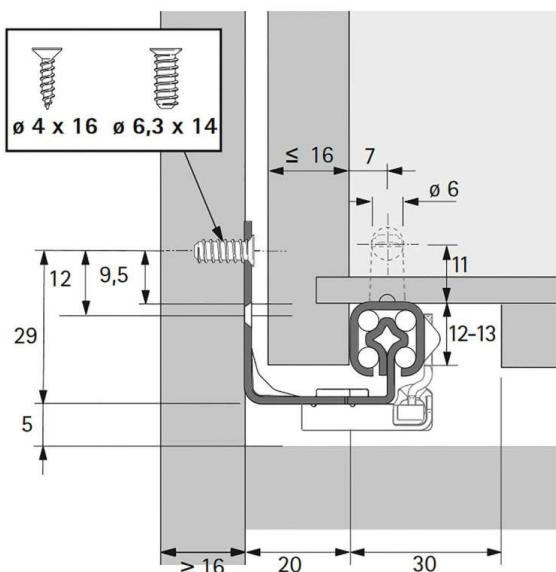
Montage par clipsage et réglage en hauteur sans outil.
