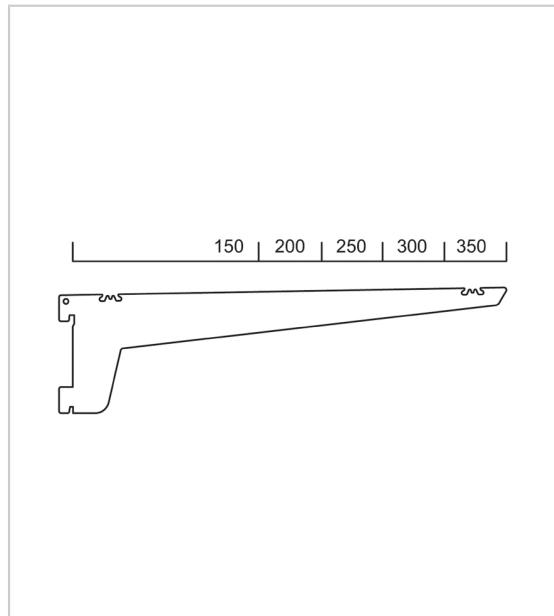
Console en aluminium au pas de 37mm, avec encoches pour pose de cavaliers A1 ou A2 en plastique permettant la mise en place d'une tablette.
