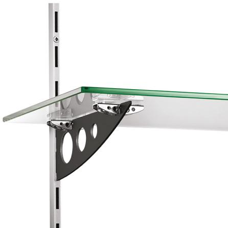
Console en aluminium au pas de 37mm, avec encoches pour pose de cavaliers A1 ou A2 en acier permettant la mise en place d'un tablette.
