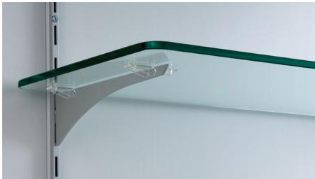
Console en aluminium au pas de 37mm, avec encoches pour pose de cavaliers A1 ou A2 en plastique permettant la mise en place d'une tablette.
