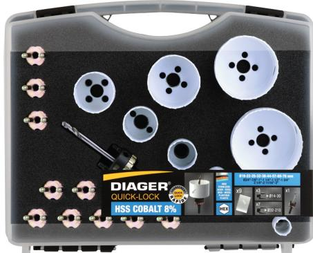
Idéal pour les travaux de maintenance applications : inox, composite, aciers alliés et bois tendre composition : - trépan HSS Cobalt 8 % Ø 19/22/25/32/38/44/57/68/76 mm - 1 pilote Quick-lock hexagonal 9,5 mm avec foret centreur - 10 connecteurs.
