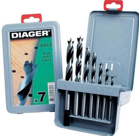
Applications : bois dur, stratifié, bois tendre et contre plaqué pointe auto-centrante 2 arêtes de coupe, large listel poli attachement cylindrique composition : Ø 3 - 4 - 5 - 6 - 7 - 8 - 9 - 10 mm.
