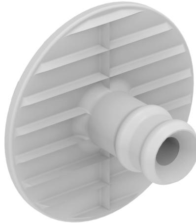
Le clip mâle SL-M18 se fixe sur le panneau et se clipse sur le clip femelle SL-FA ou le SL-FB ou le SL-SFA pour permettre un montage rapide de panneaux sur des rails alu ou fourrures acier.
