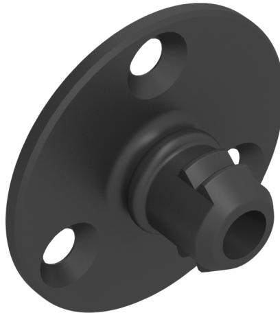
Clip très haute tenue avec une charge de retrait de 15kg et une résistance élevée au cisaillement (100kg). Il est conçu pour le montage de panneaux de plafond ou muraux lourds.
