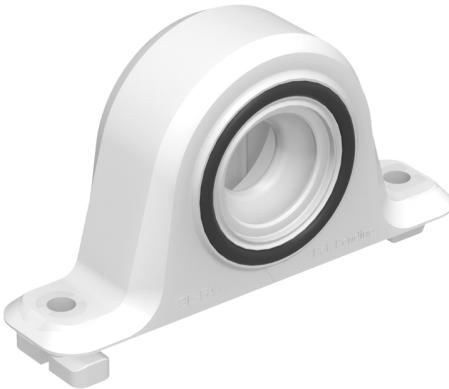
Le clip femelle SL-FAFR permet une installation rapide de panneaux lourds horizontaux ou verticaux sur des profilés en alu standard. Il est conçu spécifiquement pour des applications d'aménagement intérieur du bâtiment. Il est résistant au feu, donc adapté pour panneaux coupe-feu.
