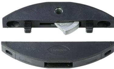
Clamex S-18 est un élément d'assemblage démontable qui se visse dans une rainure de 8mm de large. Grâce au trou d'accès minimaliste de 6mm, Clamex S-18 s'assemble et se désassemble à l'aide d'un levier.
