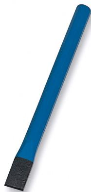
Permet de faire une saignée dans du béton, de la pierre, du moellon ou de la brique acier chrome manganèse silicium section de la tige : 16 mm taillant : 20 mm réaffûtable.
