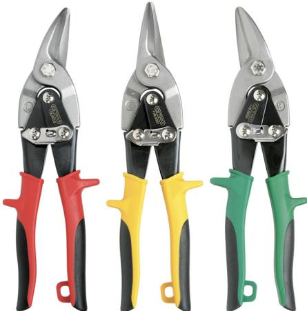
Ouverture automatique arrêt de verrouillage munie d'un trou d'accrochage lame durcie par induction poignée bi-matière coupe des tôles en acier jusqu'à Ø 1,25 mm coupe des tôles en acier inoxydable jusqu'à Ø 0,7 mm sens de coupe : 1 x à droite, 1 x droite; 1 x à gauche.
