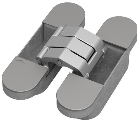
Charnière invisible TYO avec **une profondeur d'encastrement minimale de 21mm dans l'encadrement (29mm côté porte)**, permettant l'utilisation d'encadrements étroits tout en conservant son aspect invisible.
