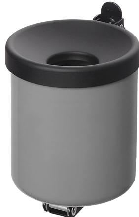
Cendrier mural en tôle pré galvanisée par électrolyse et découpée par laser, avec un revêtement par poudre époxy Anti-UV.
