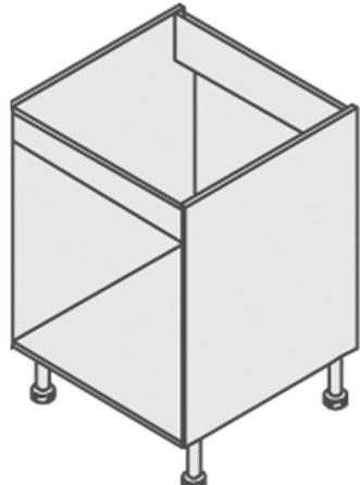
Vide sanitaire : 45 mm. Profondeur utile : 521 mm. Caisson avec pré-perçage débouchant pour vis. Embases percées pour pieds. Pieds réglables de 100 à 130 mm sont livrés avec les caissons bas. Traitement antibactérien.
