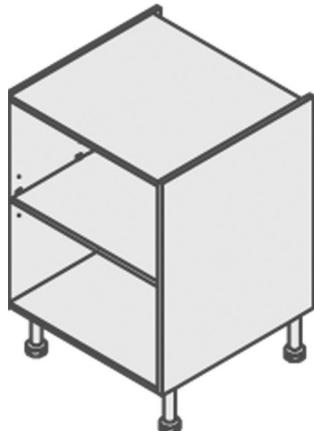
Vide sanitaire : 45 mm. Profondeur utile : 521 mm. Fonds mélaminé, épaisseur 8 mm. 1 étagère incluse. Caisson avec pré-perçage débouchant pour vis. Embases percées pour pieds. Pieds réglables de 100 à 130 mm sont livrés avec les caissons bas. Traitement antibactérien.
