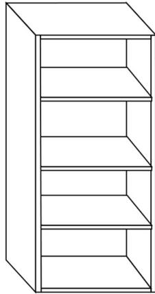
Vide sanitaire : 45 mm. Profondeur utile : 521 mm. 3 étagères incluses. Fonds mélaminé, épaisseur 8 mm. Caisson avec pré-perçage débouchant pour vis. Embases percées pour pieds. Pieds réglables de 100 à 130 mm sont livrés avec les caissons bas. Traitement antibactérien.
