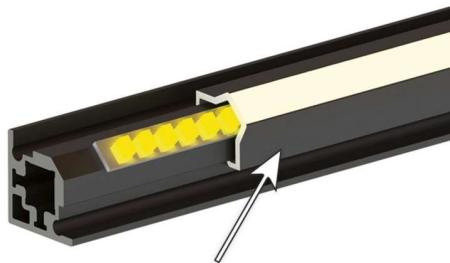
Pour la fixation de deux éléments vitrés de 4mm (verre de sécurité trempé) en combinaison avec un éclairage indirect
