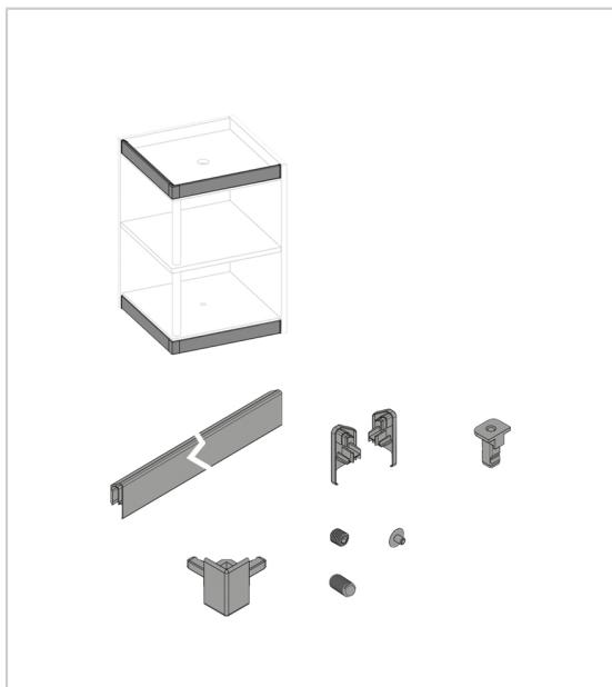
Kit d'accessoires pour le cache horizontal des ferrures FurnSpin au-dessus du panneau supérieur ou au-dessous du panneau inférieur
