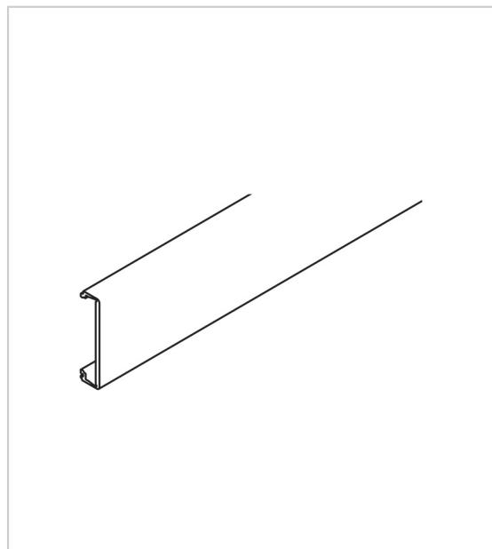
Cache à clipser sur le rail de roulement montage mural.
