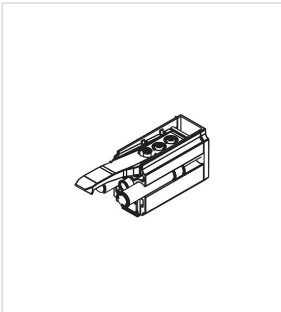
Butée SoftStop (amortie) avec ressort de blocage.
