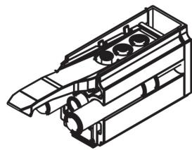
Butée SoftStop (amortie) avec ressort de blocage.
