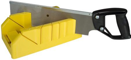
Boîte à onglets plastique 350 x 95 x 143 mm corps en ABSsystème de rangement de la scie incorporé 3 angles de coupe 45°, 90° et 22,5 ° fournie avec une scie à dos.
