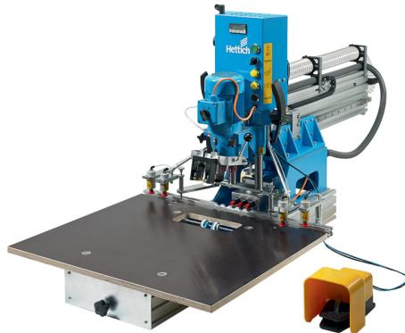
Perceuse et presse automatique avec ou sans mécanisme de perçage interchangeable.
