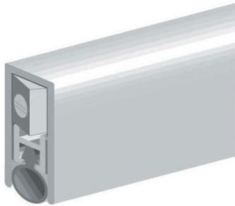
Pour tous types de porte, à fleur ou à recouvrement bas de porte rétractable en aluminium naturel tout comme son mécanisme intérieur mécanisme intérieur muni d'un joint tubulaire en silicone souple permettant une étanchéité parfaite lors de la fermeture de la porte réglage de la descente de la plinthe grâce à un pousoir système automatique d'adaptation aux faux niveaux variation maximale de réglage de 10 mm descente maxi du mécanisme de 12 mm.
