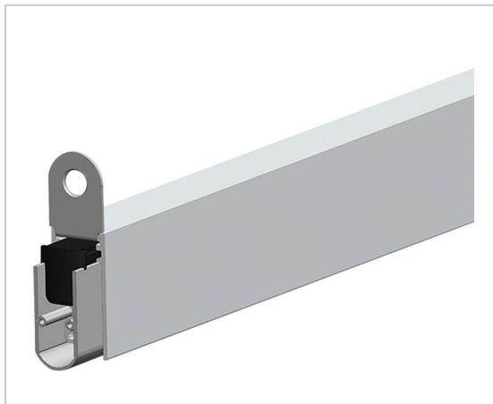
Bas de porte acoustique pour porte en bois convient aux portes coupe-feu 30 et 60 minutes course maximale 20 mm taille de l'entaille 15 x 30 mm inclinaison automatique pour les sols inégaux.
