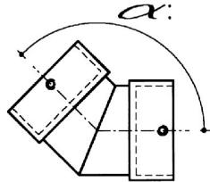
Angle sur mesure 90° à 175°. Pour tube Ø40.
