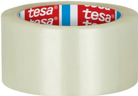
Fermerture manuelle et automatique de cartons de poids légers à moyens peut être utilisé sur tous les dévidoirs manuels et machines classiques déroulement sans bruit excellente résistance dans le temps pouvoir adhésif sur acier 2.5 N/cm allongement à la rupture 140 % résistance à la rupture 45 N/cm.
