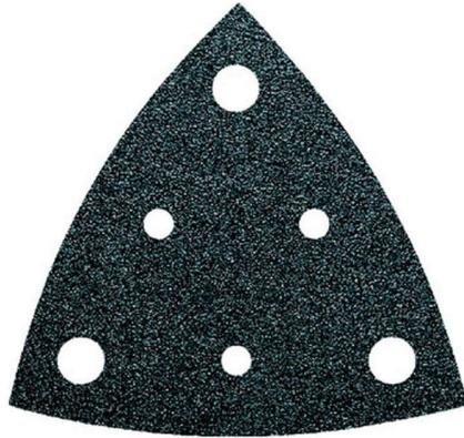
Pour le ponçage avec dispositif d'aspiration des poussières. Pour l'utilisation universelle sur pratiquement toutes les surfaces. Les grains en corindon et le liant à base de résine synthétique garantissent un fort pouvoir d'abrasion.
